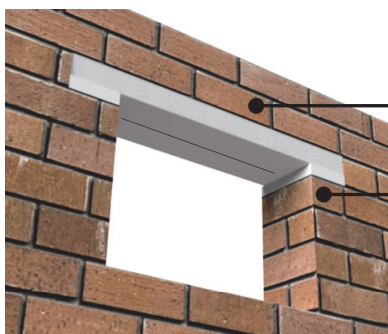
2 nosné preklady na nosnej stene 250 mm
